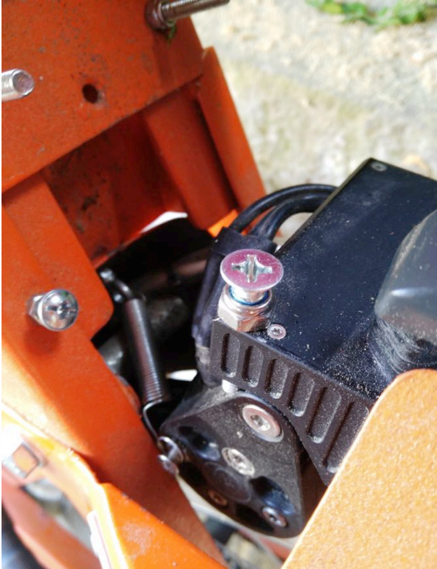
Zugfeder mit Befestigungen, gewechselte Schraube, Ersatz Madenschraube
