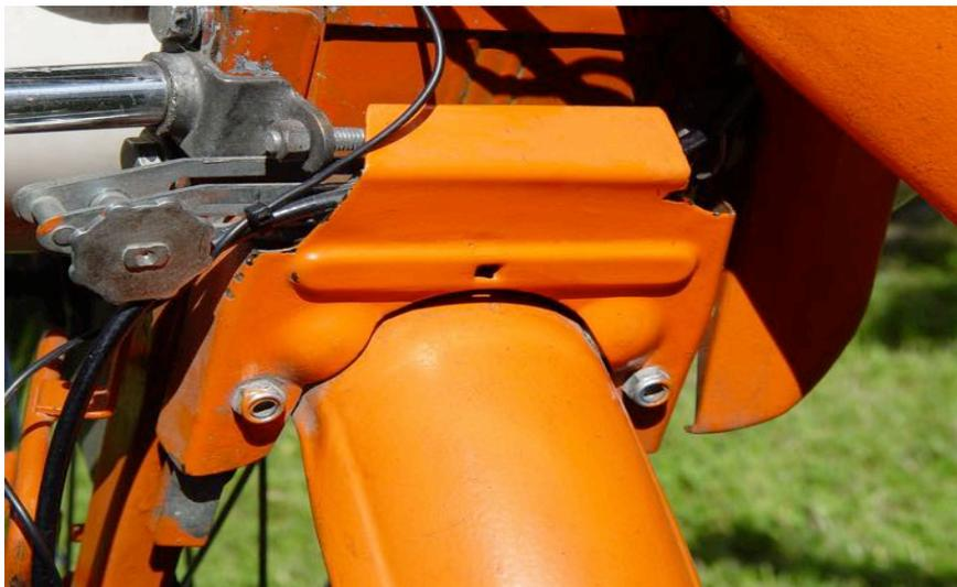
Die original Felgenbremse blieb erhalten, nur die Bremsklötze wurden entfernt und hinter dem Zentrierblech der Bremszug auf die andere Seite geführt
