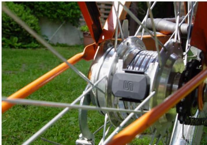
Der Speed-Sensor mit Alu-Winkel am Hinterrad
