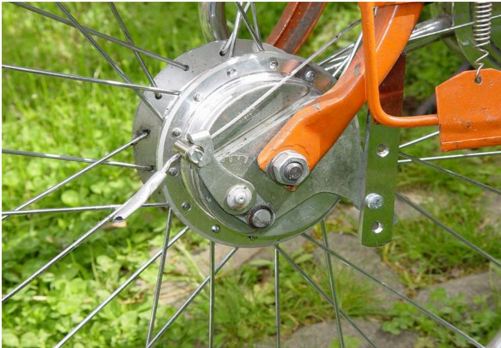
Der untere Haltepunkt des Bremsankers und der montierte Bremszug
