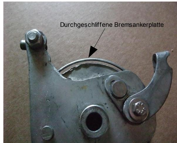
**Abbildung 2: Durchgeschliffene Bremsankerplatte**
