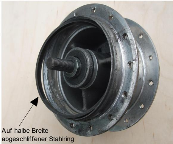
**Abbildung 1: Bremstrommel mit halb abgeschliffenem losen Stahlring**
