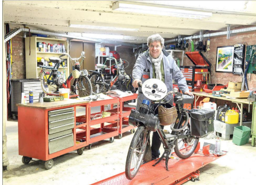
Stefan Hauck rüstet die Kult-Mofas der Marke „Solex“ zeitgemäß als Hybrid (also mit Elektromotor) um, wobei der alte, 0,7 PS starke Hilfsmotor am Vorderrad erhalten bleibt (im Hintergrund Original-Solex-Modelle). Die Batterie des Hybrids befindet sich in der Seitentasche. Foto: Rothe
